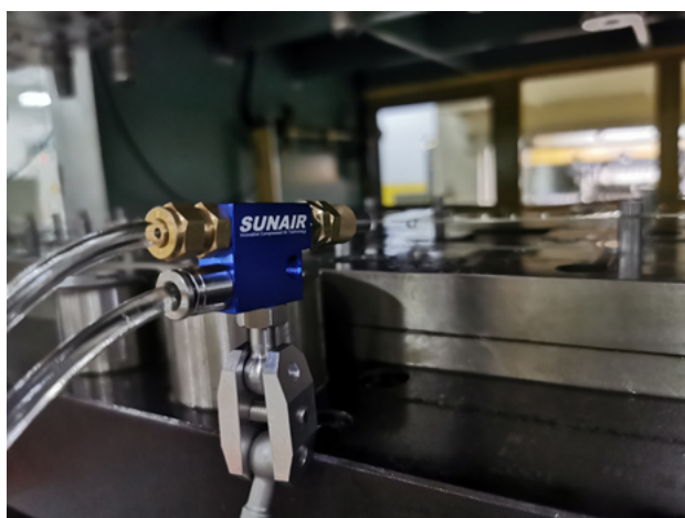
纳米喷头 冲压加工
