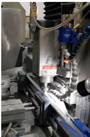
低温微量润滑 铝型材加工
